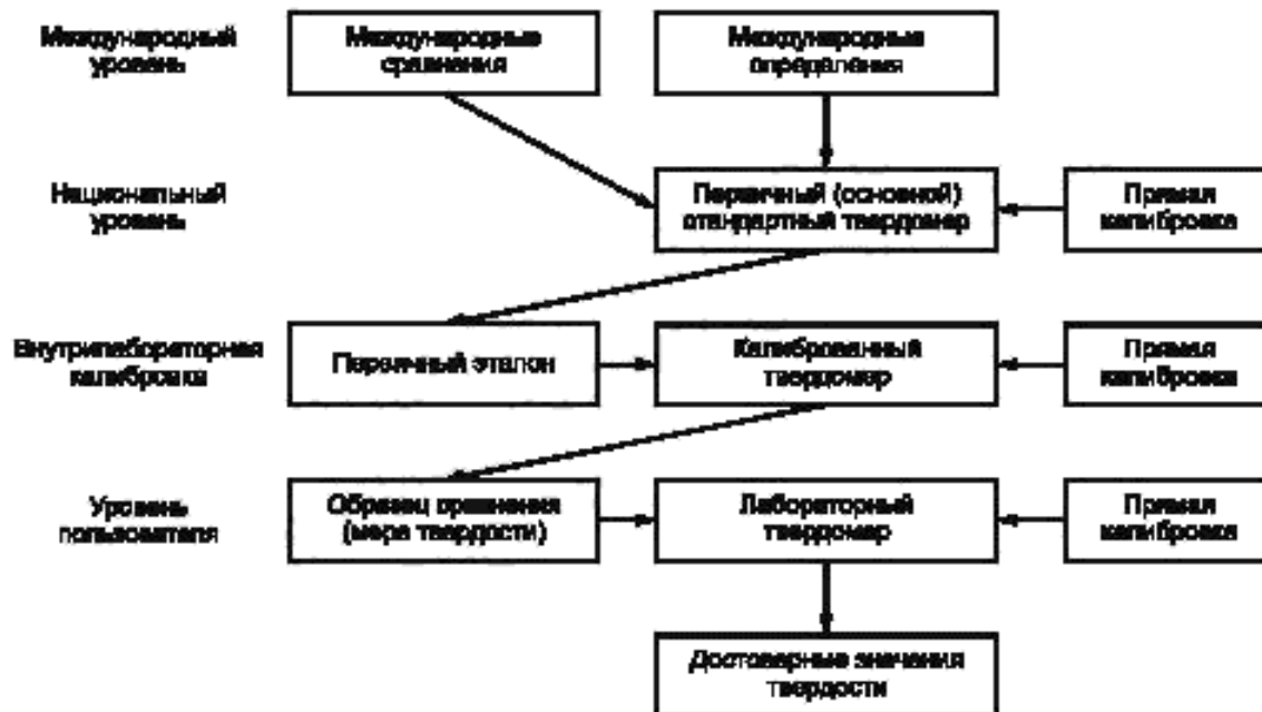
Рисунок В.1 — Структура метрологической цепочки прослеживаемости для определения и распространения шкалы твердости
