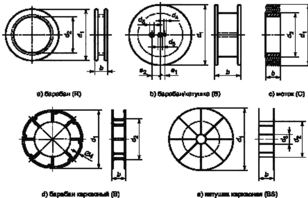
**Примечание** — Барабан/катушка (B) может иметь два отверстия под шпильки
