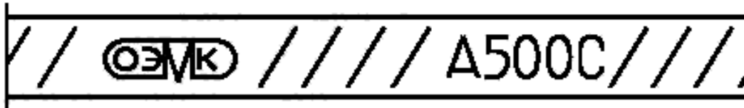
Рисунок 1 — Пример прокатной маркировки арматурного проката класса А500С производства ОАО «Оскольский электрометаллургический комбинат»
