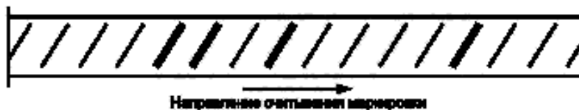
Рисунок 2 — Пример прокатной маркировки предприятия-изготовителя под номером 14
